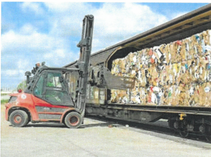
Der neue Gleisanschluss ermöglicht das gleichzeitige Entladen von vier Waggons, über die das Werk mit Altpapier beliefert.
